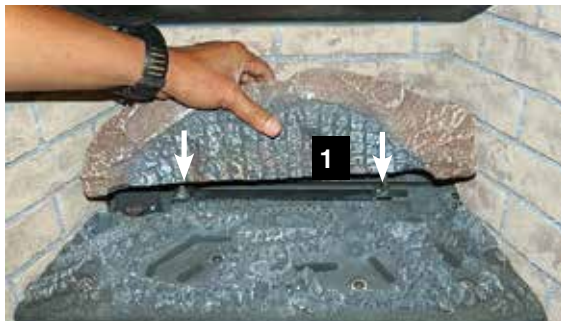
Installation de la bûche 1
