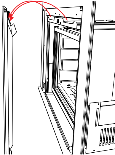
Enlever la façade avant
