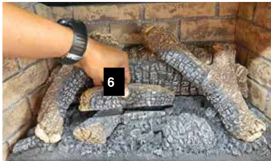
Installation de la bûche 6
