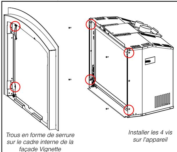
3. Installer le cadre interne de la façade Vignette en accrochant le cadre sur les 4 vis par les ouvertures en forme de trous de serrure sur le cadre. Une fois en place, serrer les 4 vis.
