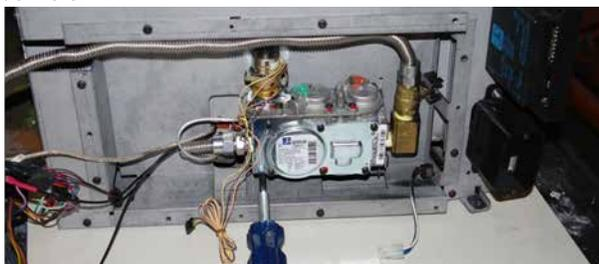
2) Desserrer à moitié les deux vis situées sur le dessus de la valve. Soulever le corps de la valve et l'incliner vers l'extérieur. Les ferrures de fixation de la valve restent ouverts comme illustré à droite de la photo ci-après.
