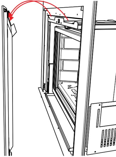
2. Retirer la partie externe de la façade en enlevant les vis : 5 vis pour le modèle L/HRI4E et 6 vis pour le modèle L/HRI6E, comme illustré ci-dessous.
