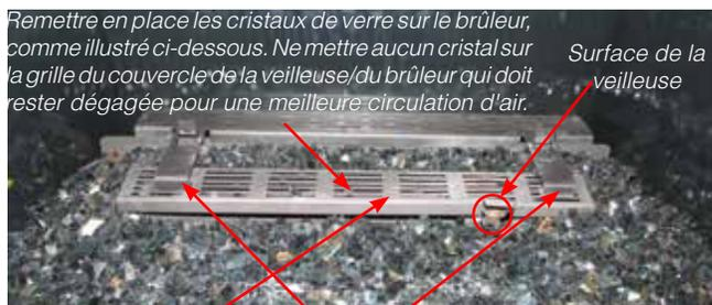
Remettre en place les cristaux de verre sur le brûleur, comme illustré ci-dessus. Ne mettre aucun cristal sur la grille du couvercle de la veilleuse/du brûleur qui doit rester dégagée pour une meilleure circulation d'air.
