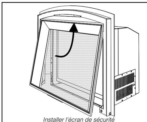
5. Installer le cadre externe de la façade Vignette dans le cadre interne en plaçant les languettes dans les fentes situées sur le cadre interne de la façade Vignette. La partie inférieure de la façade extérieure est maintenue par des aimants.
