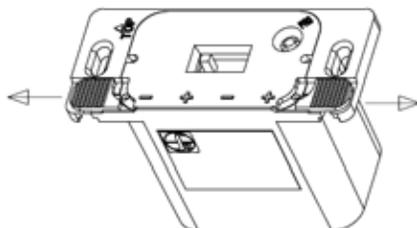
Le compartiment à piles peut être légèrement sorti pour permettre de l'extraire facilement
