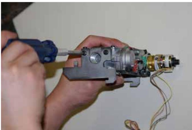
**11)** Un point de prise est prévu sur le corps de la valve en fonte pour fixer d'autres composants et peut servir à maintenir la valve dans un étau.
