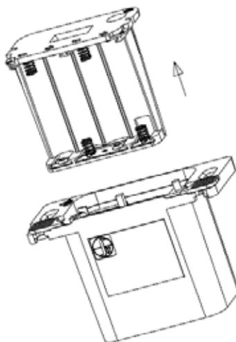
Remplacer les 4 piles AA et insérer à nouveau le compartiment à piles dans le récepteur à distance ou le porte-piles
