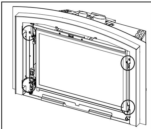
4. Installer l'écran de sécurité dans le cadre interne de la façade Vignette en soulevant légèrement le cadre de l'écran de sécurité et en le plaçant dans le cadre de la façade Vignette. Laisser l'écran de sécurité se mettre en place avec le cadre de la façade Vignette.
