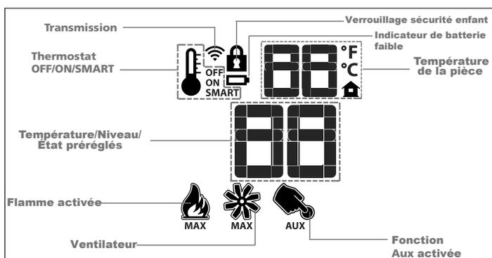
Schéma 2 : Afficheur LCD de la télécommande
