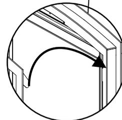
6. Faire passer le câble d'alimentation sur la gauche pour le brancher à la prise la plus proche avant de glisser l'appareil dans son emplacement final.
