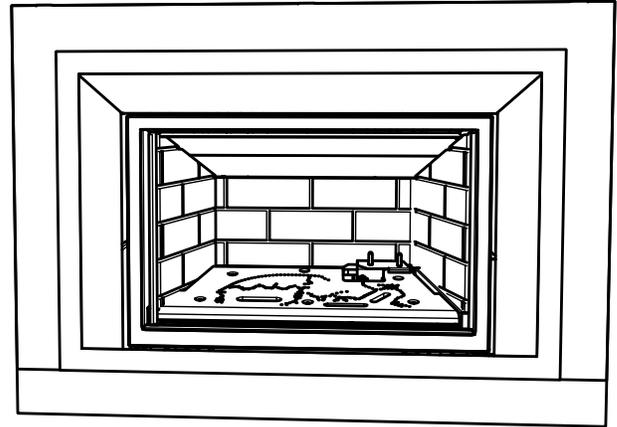
2. Installer la partie externe de la façade en accrochant le rebord à l'arrière de celle-ci sur le crochet, tel qu'illustré ci-dessous.
