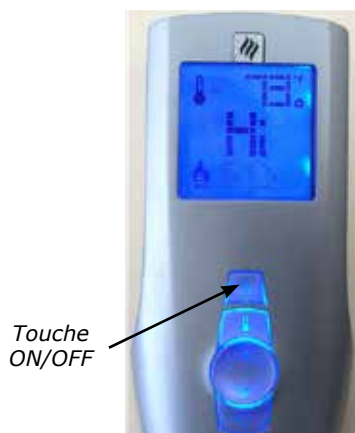
Schéma 2 Télécommande en mode Manuel sur Hi
