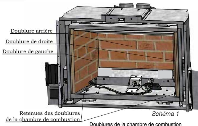
1. Sortir les ferrures de calage gauche et droite de l'appareil, tel qu'illustré ci-dessous. Les mettre de côté.
