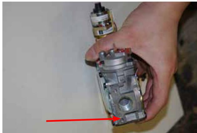
**12)** Placer la valve dans un étau en la serrant au niveau de ce point de prise, comme décrit plus haut. Éviter de trop serrer. Dévisser le raccord conique à la sortie de la valve.
