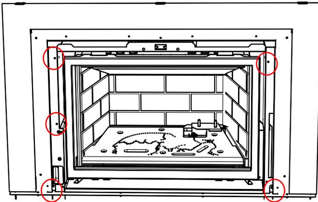
3. Fixer la plaque de support sur la partie externe de la façade depuis l'avant de l'appareil à l'aide de 7 vis (3 le long de la partie supérieure et 2 de chaque côté).
