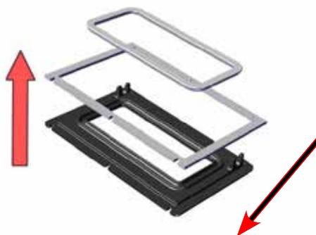
3. Dévisser les 3 écrous arrière, puis retirer les 3 écrous à l'avant. Soutenir la trappe du registre de dérivation à l'avant et à l'arrière et la faire glisser vers l'avant pour la retirer.
