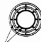
Manchon d'emboîtement ventilé (en tôle) équipé de 2 conduits d'air espacés de 1 po (25 mm) chacun
