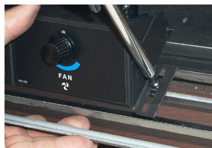
Visser la grille avec une vis à droite.
