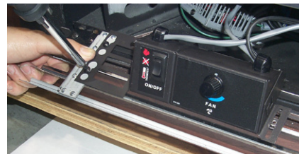
Visser la grille avec deux vis à gauche.
