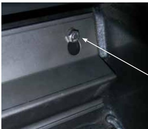
S'assurer que le déflecteur est bien en place de manière à ce que les boulons soient placés sur le haut du trou en forme de serrure avant de serrer les boulons.
