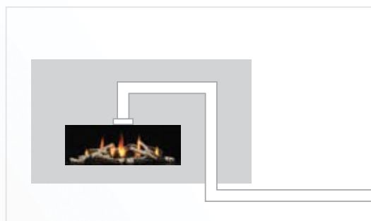
Évacuation forcée horizontale affleurante fin de ligne avec longueur de conduit négative
