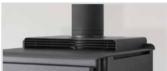
Le convecteur Airmate recueille l'air très chaud situé à l'arrière et au-dessus du poêle pour le faire circuler à l'avant dans la pièce. Cette répartition de chaleur réduit la température à l'arrière de l'appareil et permet de placer ce dernier plus près d'un mur.
