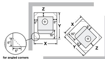
**REMARQUE :** Au Canada, la protection de plancher doit s'étendre sur 18 po (457 mm) à l'avant et 8 po (203 mm) à l'arrière du poêle. Si le dégagement arrière par rapport aux matériaux combustibles est inférieur à 6 po (pour les installations en angle), les angles arrière peuvent être ajustés pour profiter de dégagements plus étroits.
