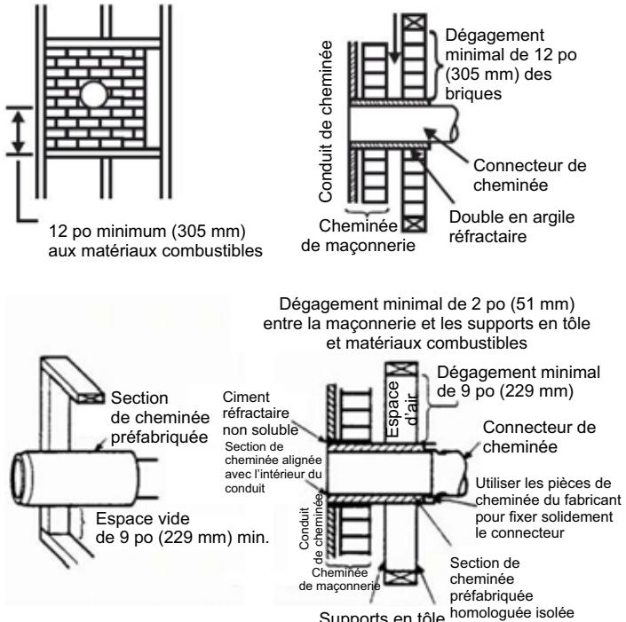
Dégagement minimal de 2 po (51 mm) entre la maçonnerie et les supports en tôle et matériaux combustibles
