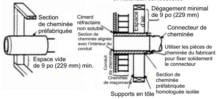
Dégagement minimal de 2 po (51 mm) de la cheminée aux supports en tôle et matériaux combustibles
