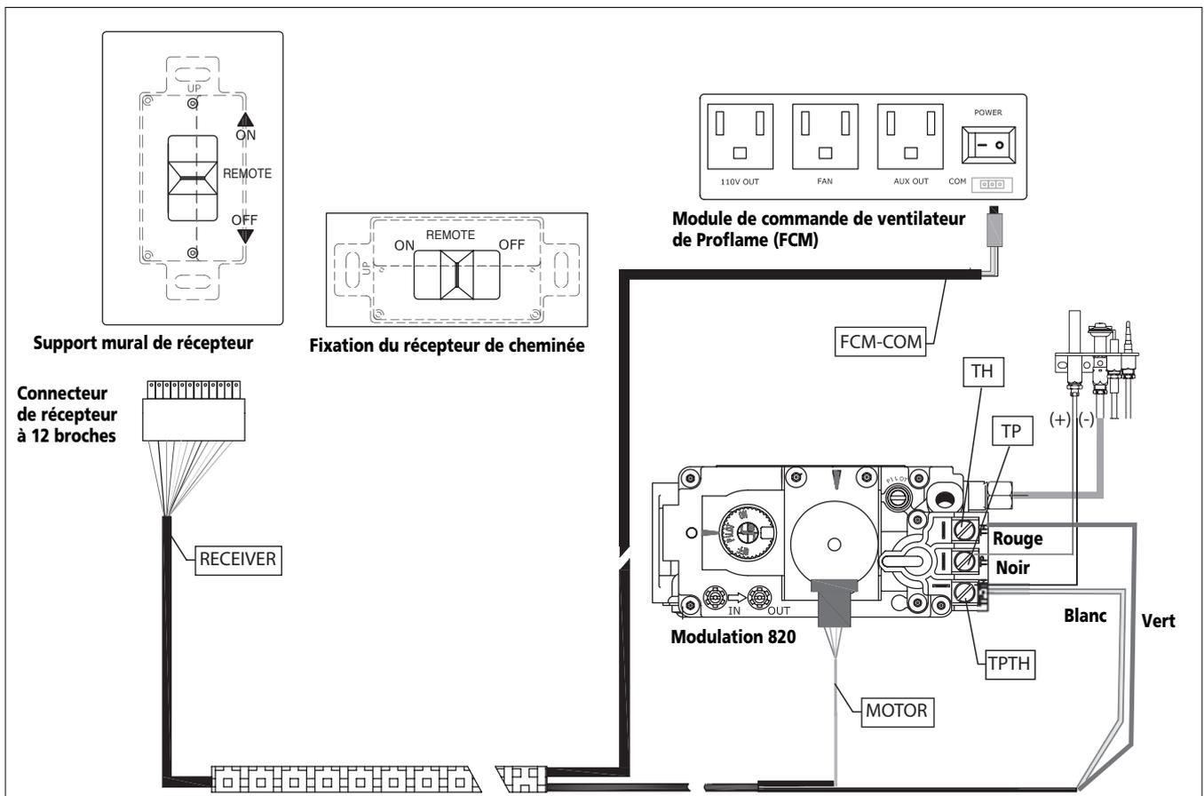
Fig. 5: Schéma de câblage.
