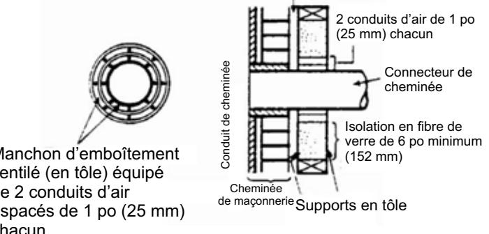
Dégagement minimal de 2 po (51 mm) de la cheminée aux supports en tôle et matériaux combustibles
