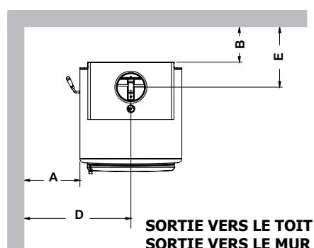
**REMARQUE :** Cet appareil est homologué pour être utilisé avec un conduit à paroi double. Ne pas utiliser de conduit à paroi simple.
