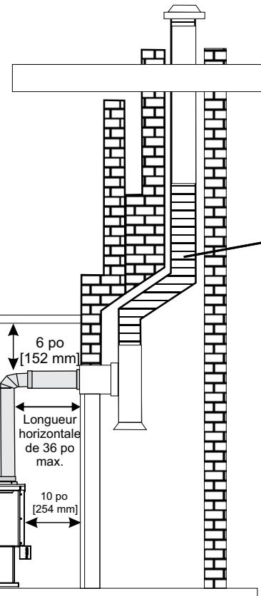
**REMARQUE :** Le conduit doit être de 8 po (203 mm) de diamètre. Cette cheminée ne peut pas être réduite en section transversale.
